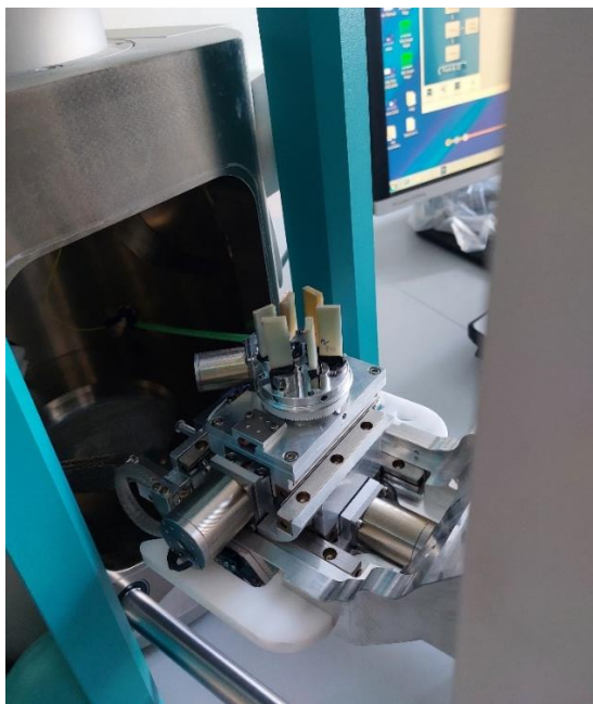
Слика 4-10. 6 примероци поставени во комората на микроскопот за тестирање.
