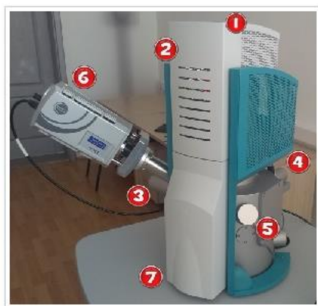
Слика 4-9. Електронски микроскоп за оптичко скенирање модел VEGA3 LMU со основните составни компоненти.
