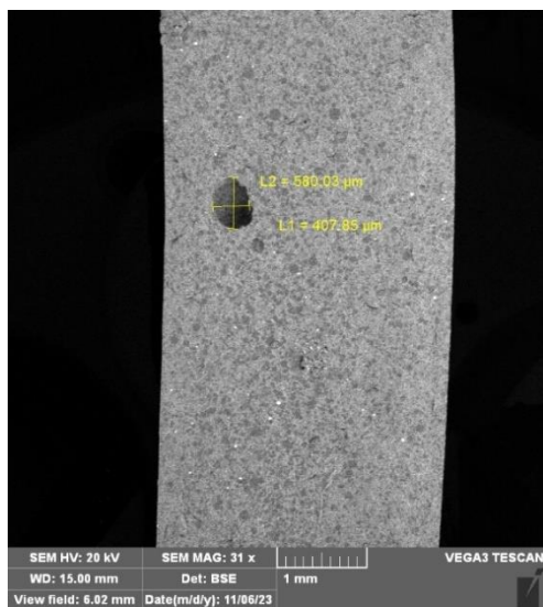
Слика 6-3. Примерок од групата ИНК В 2,5%. А. Видлива микропора со измерени димензии (жолта боја) и помала микропора под неа (зголемување 31x). Б. Помалата микропора од сликата А на поголемо зголемување (410x).
